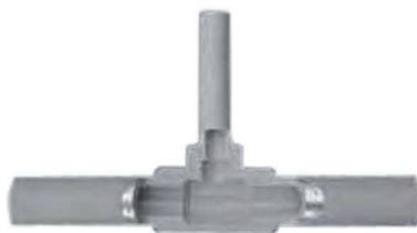
Рис. 44 Сварное соединение в разрезе
