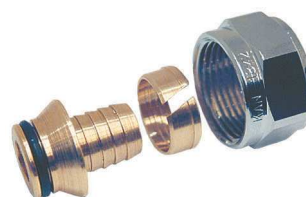
Рис. 37 Соединитель конусный для труб PE-RT и PE-Xc - обжим конусный с разрезанным кольцом
